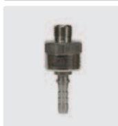
1/4" AG. Edelstahl. 1-fach gelagert. Max. 275 bar / 120 °C
