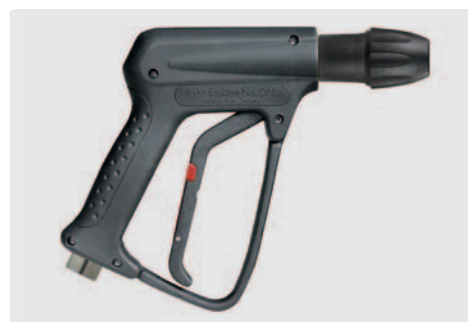
Professionelle Pistole R+M EcoLine No. ONE mit Kupplung KW. Max. 250 bar / 45 l/min / 150 °C
