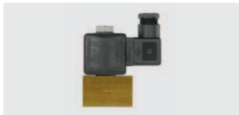
1/4" IG. NW 1,5 mm. Magnetventil mit Steckdose. Druckbereich 0 - 130 bar. Max. 90 °C
