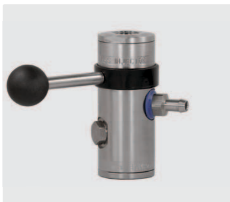
1/2" IG : 1/2" IG - Tülle 9 mm. Regulierung der Chemiedosierung erfolgt durch 8 auswechselbare Dosiereinsätze (0,5 - 1,5 mm).
