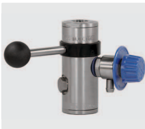
1/2" IG : 1/2" IG - Tülle 9 mm. Injektor ST-167 mit Dosierventil ST-161. Max. 350 bar / 100 °C
