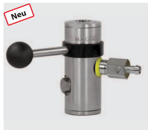
1/2" IG : 1/2" IG : Tülle 9 mm. Injektor ST-167 mit Dosierventil extreme. Max. 350 bar / 100 °C
