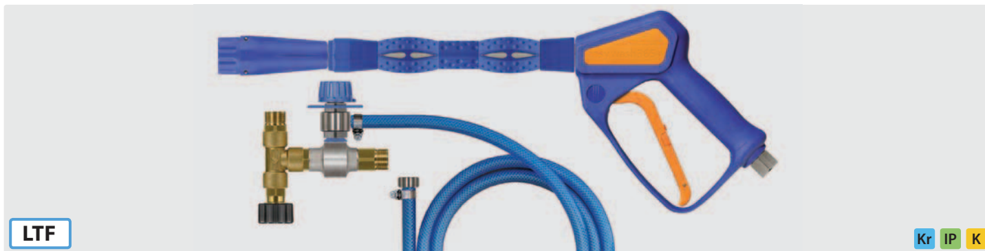
easywash365+ Schaumset: easywash365+ Schaumlanze Standard mit Schaumdüse ST-75, Injektor ST-160 (HV M22 und 2 x M22 AG) mit Dosierventil ST-161, Saugschlauch 1.000 mm und Saugfilter ST-32. Max. 310 bar / 90 °C
