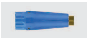
1/4" IG. Messing. ST-75 mit Düse. Max. 350 bar / 100 °C
