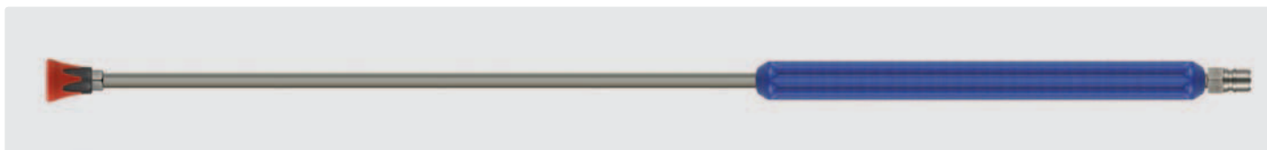
Stecknippel ST-45. Lanze aus Edelstahl mit umspritzter Isolierung und Düsenschutz ohne Düse. Max. 250 bar / 150 °C
