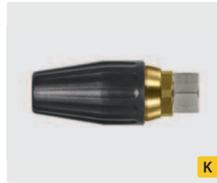
M18 IG. Spritzwinkel 20°. 100 - 250 bar. Max. 100 °C
