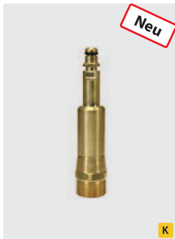
M22 AG : Stecknippel. Messing. Max. 250 bar / 100 °C
