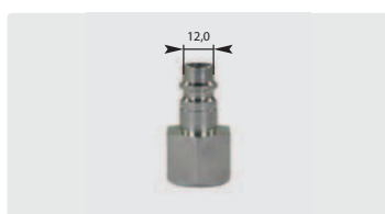
Stecknippel : IG. Ø 12 mm. Stahl vernickelt. Max. 200 bar / 100 °C
