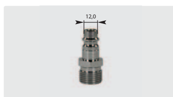
Stecknippel : AG. Ø 12 mm. Stahl vernickelt. Max. 200 bar / 100 °C
