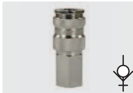
Kupplung : IG. Messing vernickelt. Mit Ventil. Max. 35 bar / 100 °C
