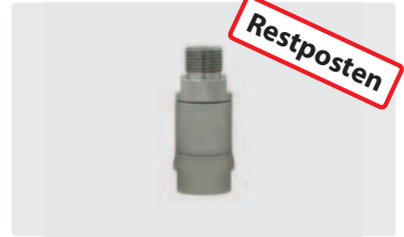
M14 AG : 1/4" IG. Messing vernickelt. Achse Edelstahl. 2-fach kugellagert. Max. 250 bar / 30 U/min / 120 °C
