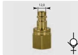
Stecknippel : IG. Ø 12 mm. Messing. Mit Ventil. Max. 35 bar / 100 °C
