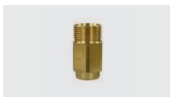
M22 AG : IG. Langbohrung. Max. 400 bar / 150 °C
