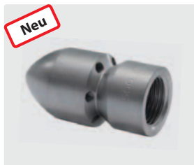
1/2" IG. Außen \varnothing 30 mm. 6 Bohrungen hinten
