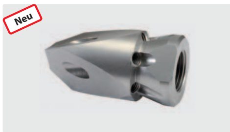
3/8" IG. Für Röhre > 50 mm. Seitliche Frontstrahlen mit gehärteten Edelstahl-Düseneinsätzen.
