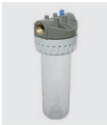
3-teilig. Entlüftungsstopfen. Innengewinde Messing. Max. 10 bar / 40 °C
