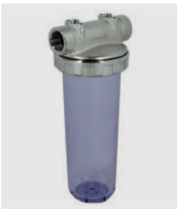
3-teilig. Entlüftungsstopfen. Kopf Messing vernickelt. Tasse Kunststoff. Max. 10 bar / 40 °C
