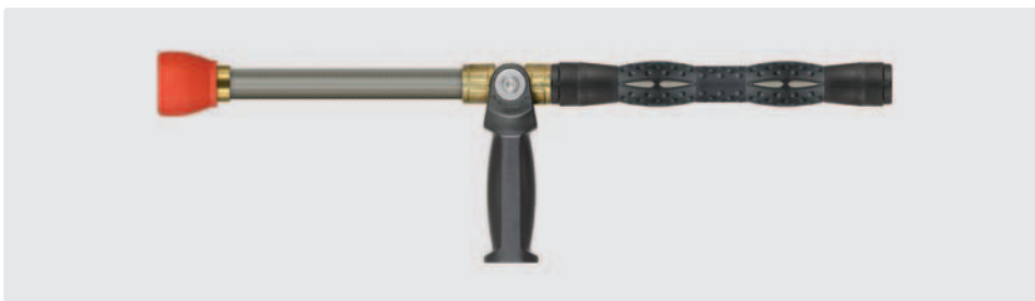
1/4" AG. Weitwurflanze 500 mm mit Isolierung ST-9.1 260 mm, seitlichem Handgriff und Düsenschutz aus Kunststoff ohne Düse. Max. 180 bar / 130 l/min
