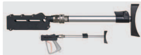
ST-3900 Schulterstützen. Neue EU-Richtlinien schreiben den Gebrauch von Schulterstützen bei Arbeiten mit einer Rückstoßkraft von mehr als 150 N zwingend vor. Stufenlos verstellbare Schulterstütze. Drehbare Kupplung. Geeignet für alle Pistolen ST-3600.
