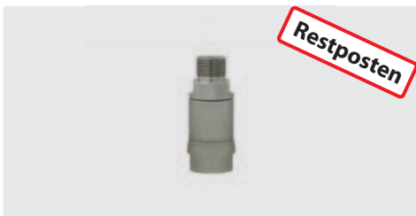
M14 AG : 1/4" IG. Messing vernickelt. Achse Edelstahl. 2-fach kugelgelagert. Max. 250 bar / 30 U/min / 120 °C
