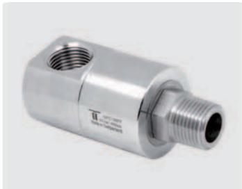
DGE 90°. Gehäuse Messing vernickelt. 1-fach kugelgelagert. Max. 275 bar
